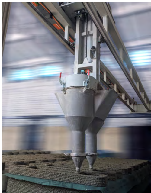
Будівельний 3D-принтер CRAFTTRUDER
